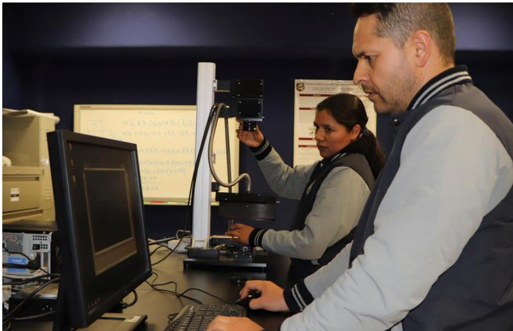
**Foto 6.** Adquisición de imágenes mediante sistema hiperespectral.
